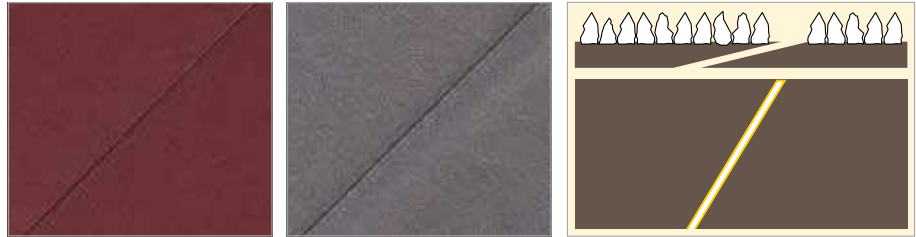
4: Düz Bindirme Yapıřtırma (Üstte Kazımasız)
