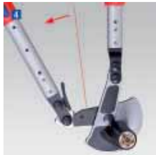
Birinci kısmı kesimden sonra kolları circırılı lokma anahtar prensibine göre açın
