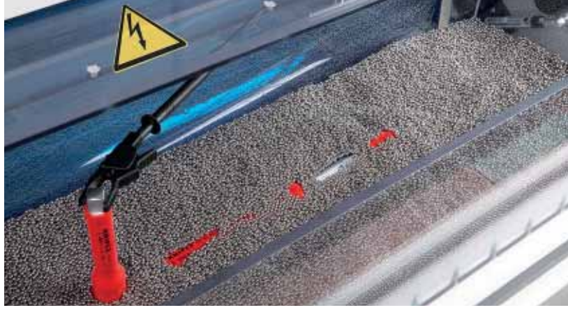
Elektriksel izolasyon özellikleri testi.
