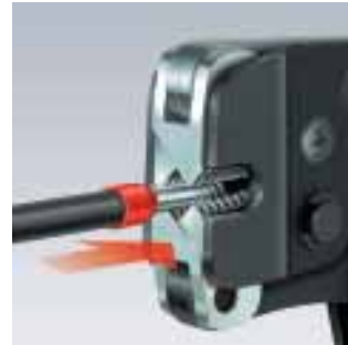
Kablo yüksüklerinin önden yerleştirilmesi, örneğin kumanda dolaplarında
