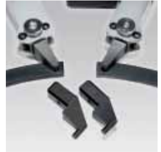
Delik ve mil segmanları için değiştirilebilir başlıklar
