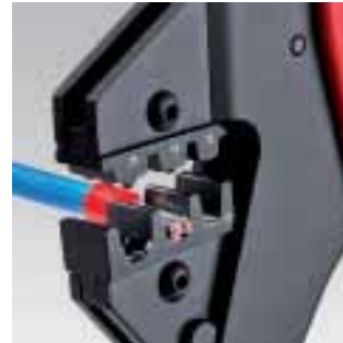
97 43 200 çantasının içerisinde sıkma kullanılan 97 49 09 sıkma çenesi bulunur
