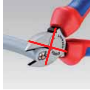
Yan keski ile geniş kablolar kesildiğinde kabloya ezilme ve deformasyon meydana gelebilir
