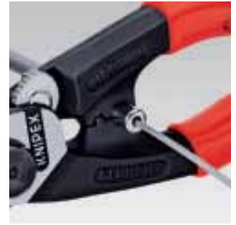
Uç kapaklarının tel mekanizması kılıfına preslenerek sıkılması
