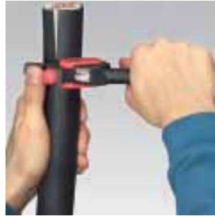
Dairesel kesim için aletin döndürülmesi
