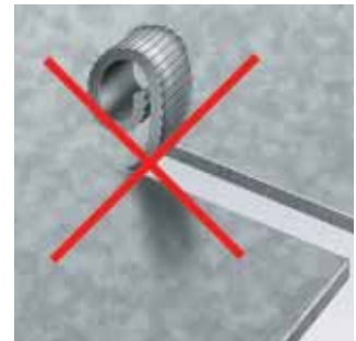
Fazlalık parça kırılmadan açılan çentik
