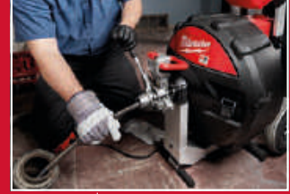
KABLO TAHRİK mekanizması otomatik olarak besler ve kabloyu geri çeker
