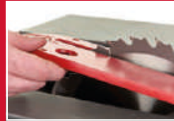
Geri tepme önleyici tırnaklar malzemeyi durdurur
