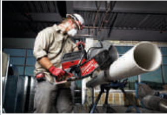
Akü ile çalışır, sıfır duman emisyonu nedeniyle iç mekan da kullanılabilir
