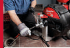
KABLO TAHRİK mekanizması otomatik olarak besler ve kabloyu geri çeker
