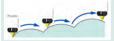
Z eksenli otomatik hareketi ile tarama ölçümü
