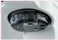
2 uç ve 4 objektif bağlantılı power taret
