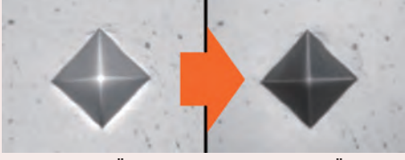
(50X) Ölçüm izi gözlem görüntüsü Ölçüm izi etrafında kaçak ışık azaltma
