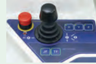
Hızlı enine ve 3 eksen konumlama için kontrol paneli
