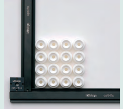
Benzer parçaların topluca ölçümü dik açılı bağlantı parçası
