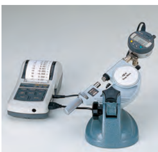
Örnek uygulama: Komparatör saati ile örnek uygulama
