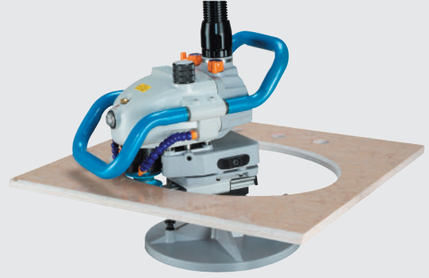
GPW510A & GPW510B'i beraber kullanarak İç Kenar Frezeleme işleminin uygulanması
